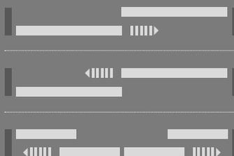
Das neue zweispurige Hebe-Schiebe-System SL 178 aus Holz ist mit barrierefreier Bodenschwelle und technisch bewährten, unten laufenden Hebe-Schiebe-Beschlägen ausgestattet. Unterschiedliche Laufwagenvarianten garantieren auch bei großem Flügelgewicht maximalen Bedienkomfort.
