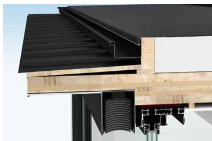
Designvariante „Gerade Kante“, abgesetzt aufgrund der Außenbeschattung
